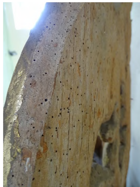
fot. 57: odwrocie fragmentu korony ołtarza, widoczne liczne otwory wylotowe drewnojadów
