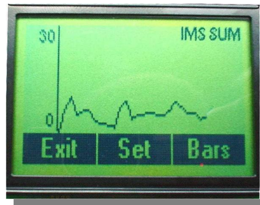
wyświetlacz z pomiarem zanieczyszczenia powietrza – bez rozpoznania rodzaju zanieczyszczenia
