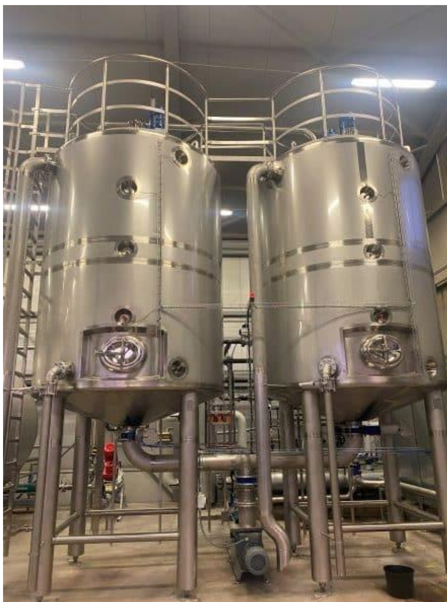
Zdjęcie nr 2. Układ zbiorników pasteryzacyjnych w wykonaniu ze stali nierdzewnej o pojemności 12m 3 wykonany i dostarczony przez firmę SJ Construction
